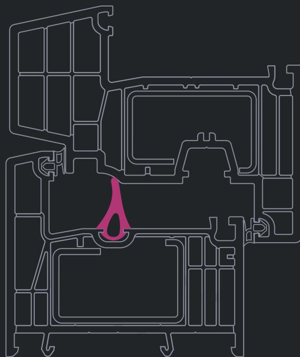
Трехконтурный уплотнитель эффективнее изолирует звук и тепло. Уплотнение из высококачественного термоэластопласта посередине системы разделяет область взаимодействия профилей, и формируются две дополнительные камеры. Окна с трехконтурным уплотнителем более надежны, менее требовательны в уходе, дольше служат. Герметичная оболочка посередине защищена от влияния низких температур, понижающих упругость резины.
